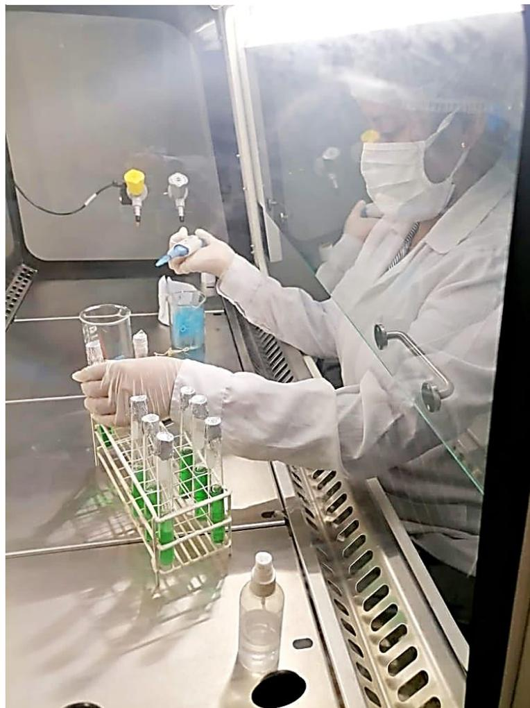
*Nota.* Utilización de micropipeta para colocar 1000  $\mu\text{L}$  de caldo para la confirmación de coliformes fecales.
