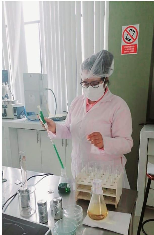
*Nota.* Se usó la micropipeta para colocar 10 ml de caldo verde brilla brillante a los tubos de ensayo.
